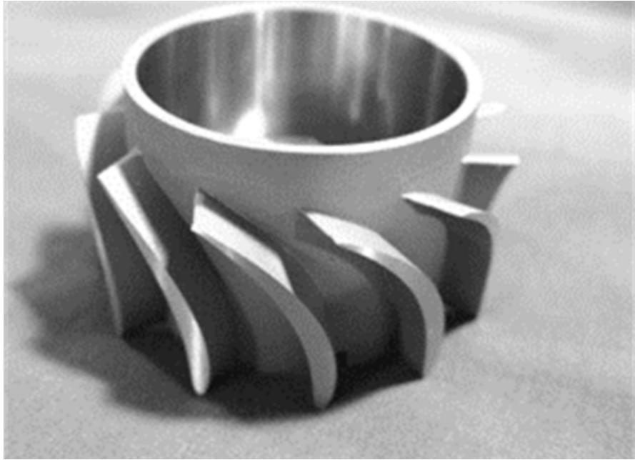
司太立6B合金是一种碳化物强化Co-Cr-W-C系高温合金，具有优良的力学性能、耐腐蚀性及耐磨性，且具有较小的摩擦系数，在不能使用润滑剂或润滑剂在高温分解、被磨蚀微粒磨损的情况下，仍然具有良好的抗卡涩、抗磨损性能，因此将司太立合金用于摩擦部件表面可提高零件的使用寿命。目前我国主要通过在零件表面堆焊司太立合金的方法来提高零件表面耐磨性，而直接应用司太立合金板材的研究较少，一定程度上限制了司太立合金的应用。司太立合金的发展应考虑钴的资源情况。司太立合金在汽车气门行业发挥着越来越重要的作用。江西非标司太立合金厂家
